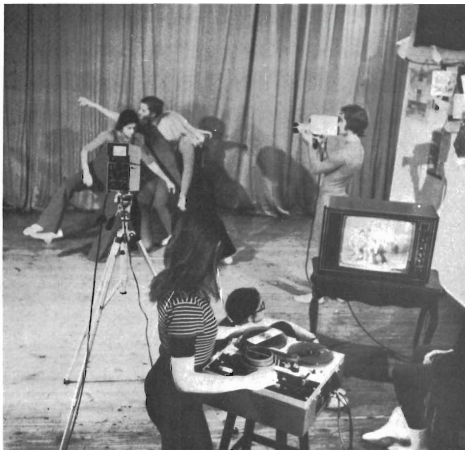
Fig. 1 - Esempio d'impiego dello "studio zero" in uno studio di danza. L'immagine inviata al monitor e al magnetoscopio è commutata per mezzo di un semplice invertitore.
