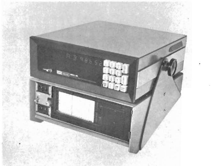
Fig. 14 - Un ricevitore per il più moderno metodo di radionavigazione: il sistema OMEGA (Modello 300). Frequenza 10,2 kHz, sensibilità migliore di 0,1 µV/m, larghezza di banda 100 Hz, ricerca automatica e simultanea di tutte le stazioni ricevute. (ITT).
