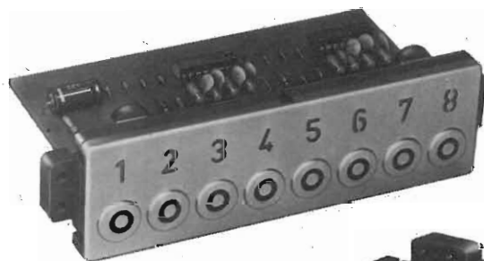
Fig. 37 - Esempio di tastiera sensoriale modello 00/0523-03, a sviluppo orizzontale.
