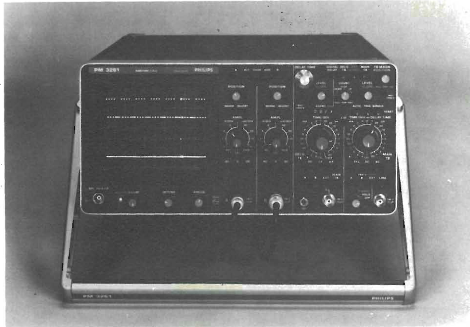
Fig. 7 - Aspetto frontale del secondo modello, e precisamente dell'oscilloscopio Philips modello PM 3261. Anche questo modello è provvisto di supporto per la posizione inclinata, e presenta a sinistra il tubo fluorescente, ed a destra i diversi comandi, razionalmente raggruppati.
