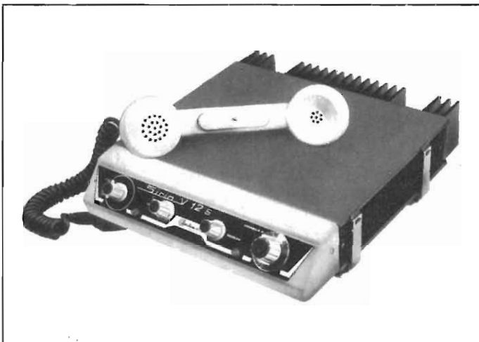
Fig. 12 - Rice-trasmettitore VHF/FM gamma 156 ÷ 174 MHz, a 12 canali, simplex e semiduplex di cui 6 quarzati (6, 9, 16, 25, 26, 27 alimentabile in tensione continua 12 e 24 Vcc (SIRM).
